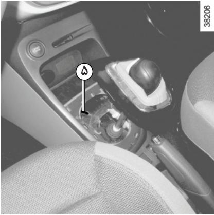
اگر هنگام راهاندازی خودرو، اهرم انتخاب دنده به رغم فشار دادن پدال ترمز در موقعیت **P** قفل شده باشد، امکان آزاد کردن آن به صورت دستی وجود دارد. برای این منظور، روکش تحتانی اهرم دنده را جدا کنید، سپس یک میله محکم را وارد شیار **5** نمایید تا قفل اهرم دنده باز شود. هر چه سریع‌تر به نمایندگی مجاز مراجعه نمایید.
