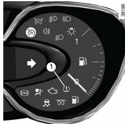
این سیستم، در صورتی که خودرو به آن مجهز باشد، کم شدن فشار باد یک یا چند لاستیک را در هنگام رانندگی هشدار می‌دهد.
