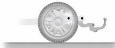
در صورتی که برجستگی سر قلاب اتصال جلوی پلاک شماره خودرو یا چراغ مه شکن عقب قرار می‌گیرد، در موقعی غیر از یک کشی آن را بردارید.
