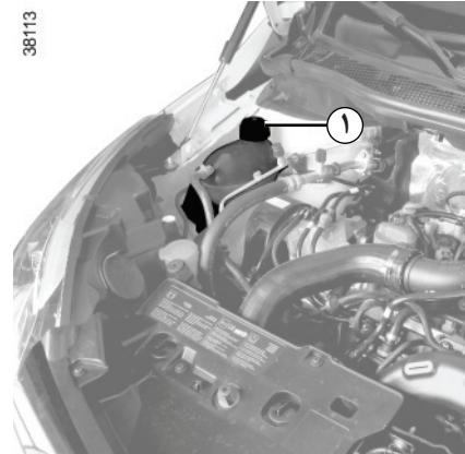
در صورت کم شدن غیر معمول یا پی دریی سطح مایع خنک کننده، به نمایندگی مجاز مراجعه نمایید.
