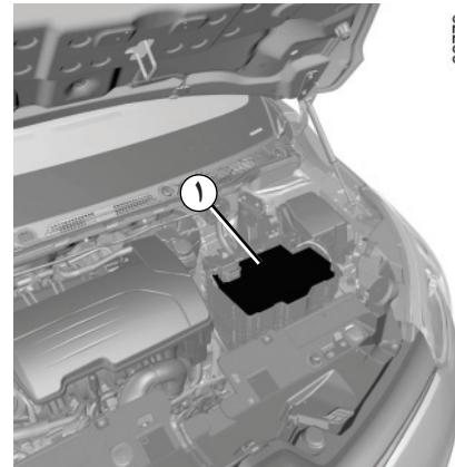
برحسب سطح خودرو، باتری ۱ زیر یک درپوش قرار گرفته و به سرویس و نگهداری نیاز ندارد.
