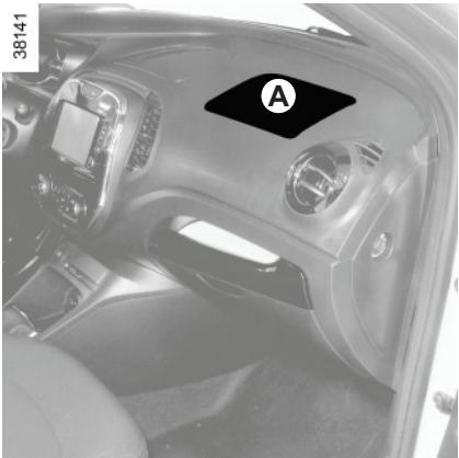
سیستم کیسه هوا براساس اصول پیروتکنیک عمل می‌کند، بدین صورت که در هنگام باز شدن تولید گرمای کرده، دود آزاد می‌کند (دودی که متفاوت از دود ناشی از آتش سوزی است) و صدای انفجار آن به گوش می‌رسد. باز شدن کیسه هوا که باید بسیار سریع انجام شود، می‌تواند باعث ایجاد جراحت یا آسیب‌های دیگر بروی پوست شود.
