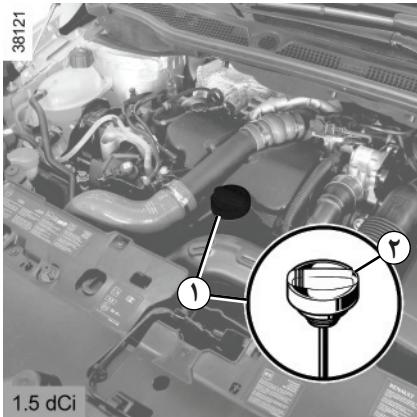
به منظور جلوگیری از سرریز شدن، توصیه می شود هنگام اضافه کردن روغن از یک قیف مخصوص استفاده کنید.
