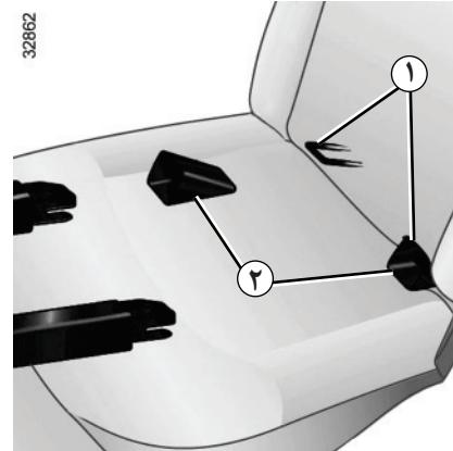
دو حلقه ۱ بین پشتی و نشیمنگاه صندلی قرار دارند و با یک علامت مشخص شده‌اند. برای نصب و قفل کردن صندلی کودک بر روی حلقه‌های ۱، ۲ راهنمایانهای نصب ۲ استفاده کنید.
