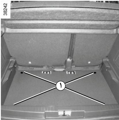
همیشه اشیاء خیلی سنگین را مستقیماً روی کف خودرو بگذارید. اگر خودروی شما به قلاب‌های مهار باشد، ۱ در کف صندوق عقب مجهز است، جهت نگهداری اشیاء از آنها استفاده کنید. وسایل را به نحوی در خودرو قرار دهید که هیچ یک از آنها در هنگام ترمز ناگهانی و شدید روی سرنشیان جلو پرتاب نشود. کمرندهای عقب را حتی هنگامی که کسی در عقب خودرو نشسته است، ببندید.
