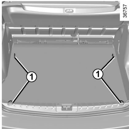
همیشه سنگین‌ترین بارها را بر روی کف محفظه قرار دهید. از تسمه نگهدارنده بار ۱ بر روی کف محفظه استفاده کنید. نحوه قرارگیری بار باید به صورتی باشد که در صورت ترمز ناگهانی هیچ وسیله‌ای به سمت بیرون و سرنشین پرتاب نشود که منجر به آسیب شود.
