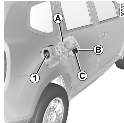
دروپوش باک سوخت: بستگی به مدل خودرو دارد. اگر باید درپوش را تعویض کنید، اطمینان یابید که درپوش جدید با مدل درپوش قبلی یکی باشد. جهت این کار با نمایندگی محازنگین خودرو تأیید تماس بگیرید. هرگز درپوش را نزدیک منبع حرارت یا شعله آتش قرار ندهید.
