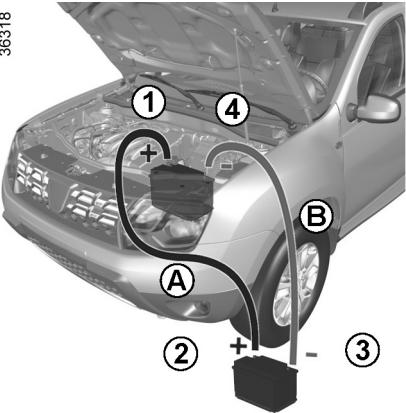
کابل مثبت (+) A را به قطب مثبت باتری خالی ۱، سپس به قطب مثبت باتری تأمین‌کننده ۲ متصل کنید.
