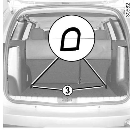
حلقه سوم واقع در هر طرف صندلی برای نصب تسمه بالایی روی برخی صندلی های کودک به کار می رود.
