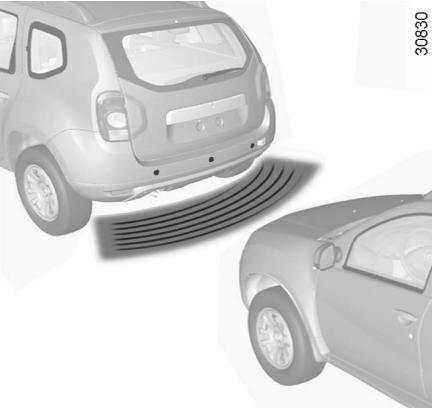
این عملکرد به عنوان تجهیزات کمکی اضافی عمل می‌کند و هنگام حرکت با دندنه عقب، فاصله بین خودرو و مانع را با استفاده از سیگنال صوتی نشان می‌دهد.
