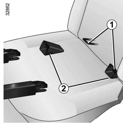
حلقه های ایزوفیکس ۱ بین پشتی صندلی و پایه صندلی قرار دارند و به راحتی قابل مشاهده هستند.
