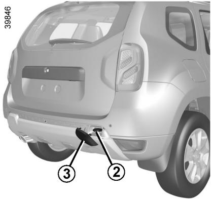
این محل های مخصوص بکسل به منظور بکسل نمودن مورد استفاده قرار می گیرد: هرگز برای بالا بردن خودرو به صورت مستقیم یا غیرمستقیم از آنها استفاده نکنید.
