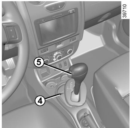
هنگام غیرفعال بودن تنظیمات اگر اهرم تعویض دنده در موقعیت P گیر کرده است، حتی با فشار به پدال ترمز آزاد نمی‌شود، می‌توانید به صورت دستی دنده را آزاد کنید. برای این کار، در پوش پایه دنده را باز کنید، همزمان، دکمه ۴ را فشار داده و دکمه ۵ را از حالت قفل خارج کنید.
