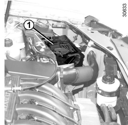
باتری ۱ نیاز به هیچگونه تعمیر و نگهداری ندارد. نباید آن را باز کرده یا مایعی به آن اضافه کنید.
