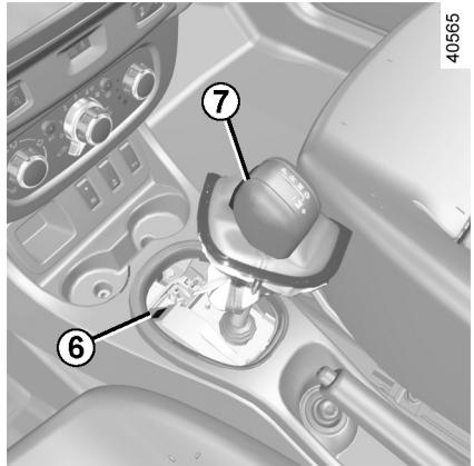
بسته به خودرو، پایه اهرم تعویض دنده را باز کنید، سپس یک وسیله (میله سفت) را وارد شیار ۶ کرده و همزمان دکمه ۷ را فشار دهید تا اهرم را آزاد کنید. هرچه سریعتر با نمایندگی مجاز نگین خودرو تماس بگیرید.
