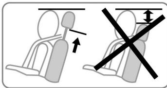
پشتسری یک وسیله ایمنی است. از نصب بودن و قرار داشتن در موقعیت مناسب آن اطمینان حاصل کنید: بالای سرتان باید با بالای پشتسری در یک خط قرار داشته باشند.
