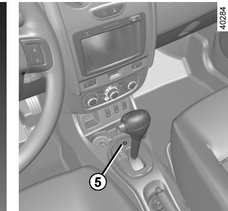
در آب و هوای سرد، ممکن است تا زمان رسیدن گیربکس به دمای مناسب، سیستم مانع تعویض دنده به حالت دستی شود.
