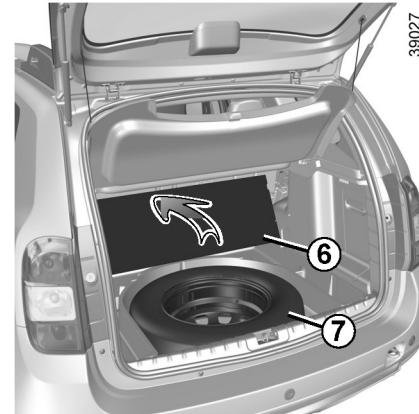
اگر چرخ زاپاس اضطراری به مدت چند سال در خودرو بدون استفاده مانده است، باید توسط نماینده‌گی نگین خودرو مورد بازرسی قرار گیرد تا این بودن آن اطمینان حاصل شود. خودروهای مجهز به چرخ زاپاس اضطراری که با چهار چرخ دیگر تفاوت دارد:
