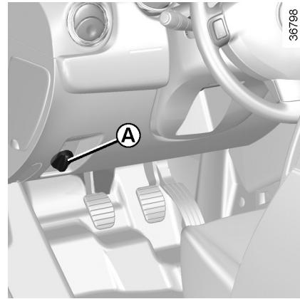
از کلید کنترل A برای تنظیم ارتفاع نور طبق شرایط بارگیری خودرو استفاده نمایید.
