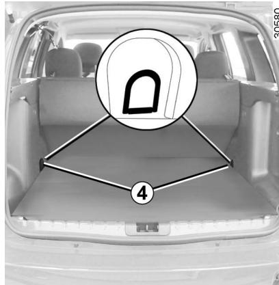
قلاب روی تسمه را به یکی از حلقه های ۳ (مدل ۲ چرخ محرک  $2 \times 4$ ) یا ۴ (مدل ۴ چرخ محرک  $4 \times 4$ ) وصل کنید.
